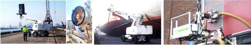
**Nettoyage, décapage et peinture par robot pour chantiers navals**
