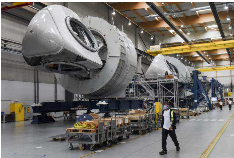
Fabrication de l'éolienne offshore Haliade 150-6 MW à l'usine General Electric de Montoir-de-Bretagne (Loire-Atlantique)
