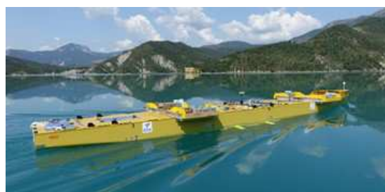
Essai de tenue à la mer sur modèle libre de DGA TH
