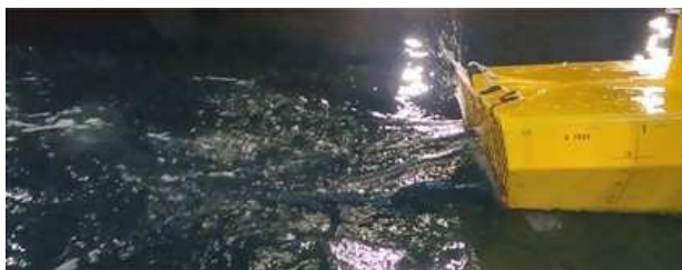
Essai de tossage sur tableau arrière de frégate
