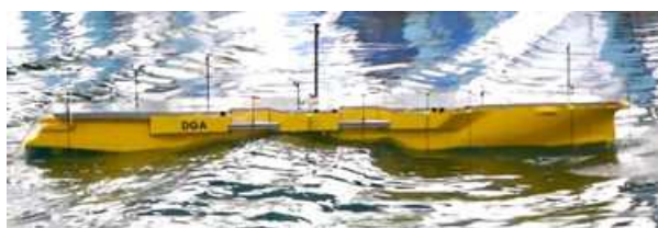
Essai de manœuvrabilité sur modèle libre de DGA TH au lac de Castillon
