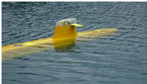
Essai de SNLE 3G sur modèle libre
