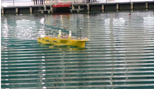
Essai de tenue à la mer sur modèle libre du PA NG
