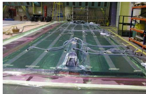
Figure 28 : Platelage en cours d'infusion sur le marbre
