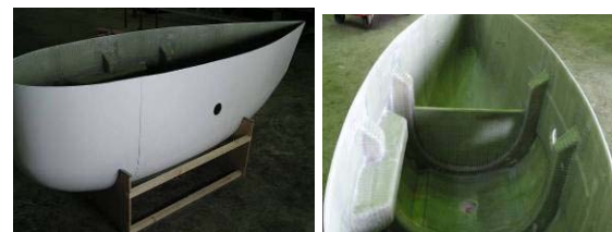
Figures 21 et 22 : Pièce démoulée
