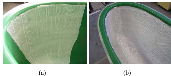
Figure 9 : Drapage tissus préencollés (a) ou secs (b)
