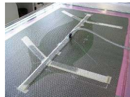
Figure 6 : Rampes en feuille (ou arête de poisson)
