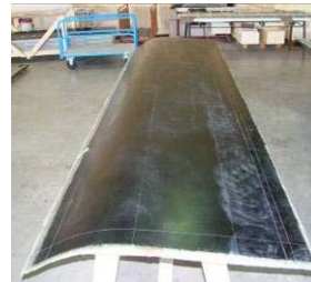
Pièce de jonction après démoulage
