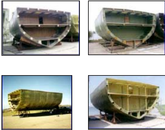
Figure 23: Comparaison de différents procédés pour la réalisation de coques de navires (Photos du haut : démonstrateur réalisés par infusion, photos du bas, démonstrateurs en technologie prepreg)
