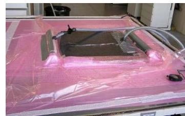
Figure 16 : Essais préliminaires d'infusion en forte épaisseur monolithique
