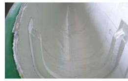
Figure 14 : Drapage de membrures
