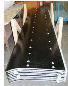
Pièces de jonction après détourage et perçage (prêtes à être livrées)
