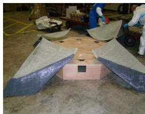
Préparation du collage des 4 éléments
