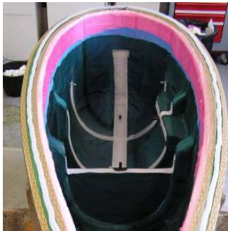
Figure 18 : Positionnement des éléments de drainage
