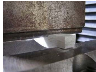
Figure 10 : Essai de délaminage en flexion sur éprouvette réalisée à partir de tissus préencollés
