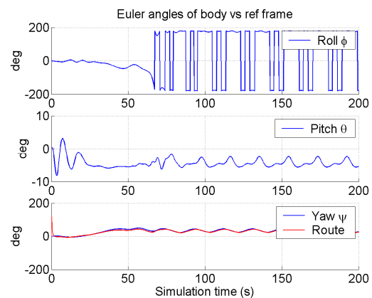
Figure 9 : Signaux temporels de roulis, tangage et lacet pour la première condition de houle (simulateur).
