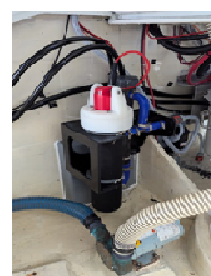
Figure 3 : TSG Gaillard installé à bord d'un des bateaux du Vendée Globe
